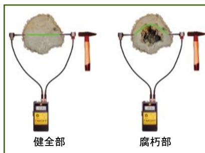
応力波速度測定のイメージ
