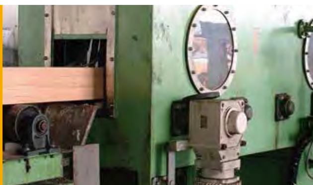
全面超噴射処理装置
