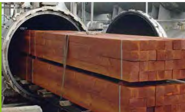
加圧式保存処理装置
