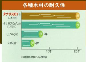
\*加圧注入処理とは、木質材料を専用の注薬缶に入れ、 高い圧力をかけて材料内部に薬剤を含浸させる方法です。 \*この処理を行うことで、木材強度を損なう事なく信頼性の 高い防腐・防蟻効果が得られます。
