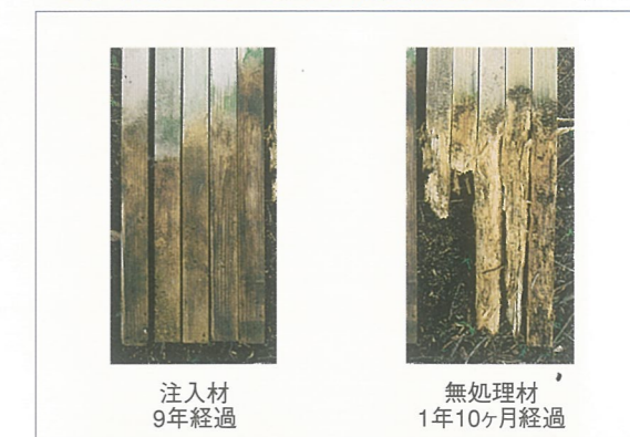
ペンタキュアニューBM注入材と無処理材 (図2)
