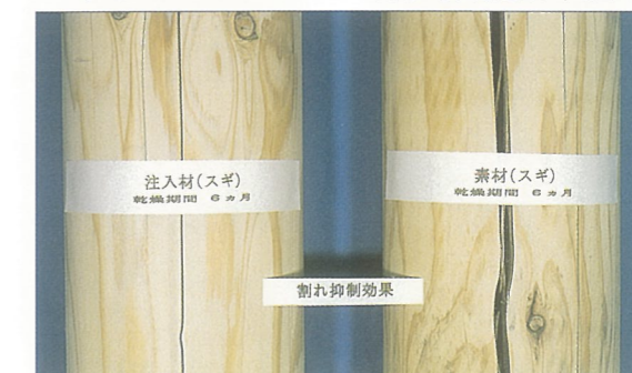
ペンタキュアニューBMによる干割れ抑制効果 (図3)
