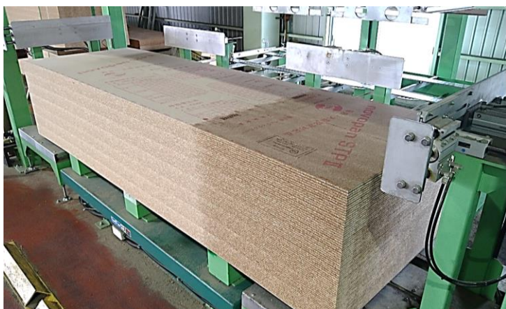
■パーティクルボードへの乾式表面処理
